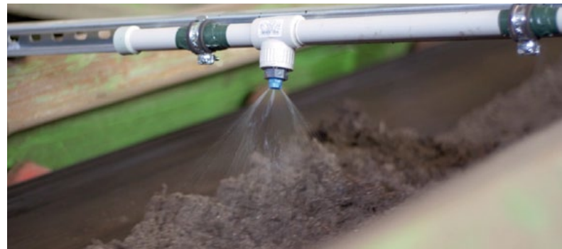
Sprühdüsen über dem Förderband benetzen das Substrat
